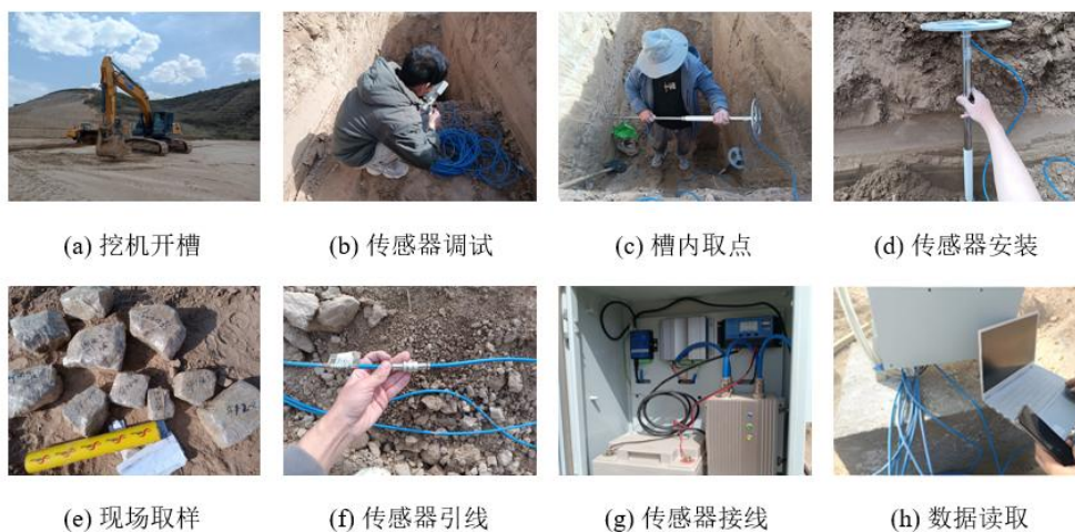
图 3 单点传感器埋设及数据读取
